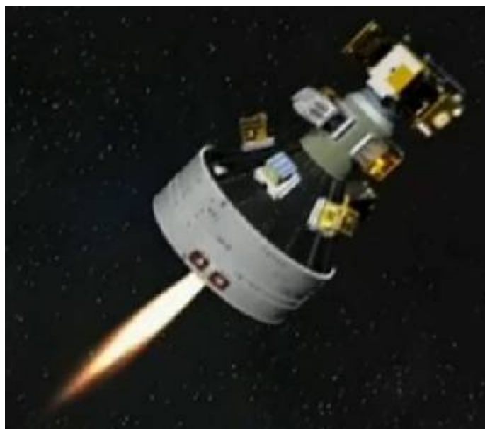
Рисунок 15. Внешний вид 3-й ступени РН Chang Zheng-6 (CZ-6) с установленной на ней полезной нагрузкой
