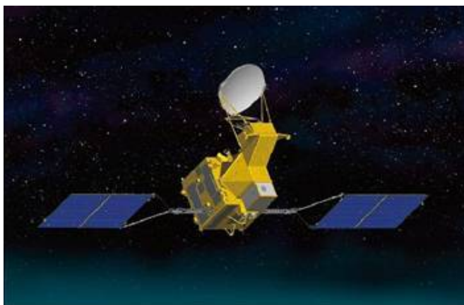
Рисунок 24. Общий вид КА GCOM W1 (Shizuku), видна антенна радиометра AMSR-2
